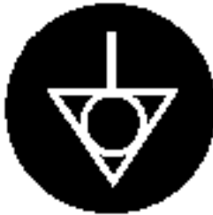
MISE À TERRE RÉSEAU
